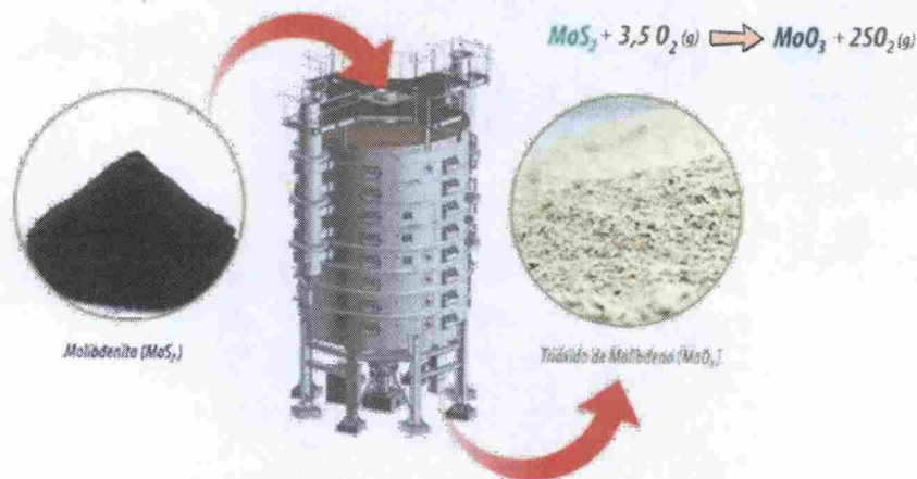
Transformación de la Molibdenita a Trióxido de Molibdeno
